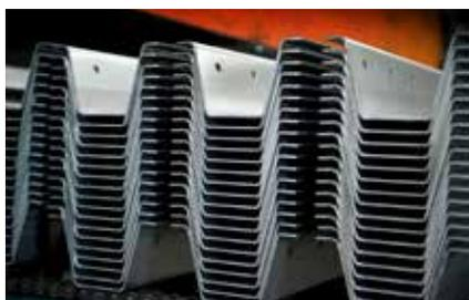
Nuestros **refuerzos de alto límite elástico** fabricado en acero galvanizado mejoran el peso del silo lo cual facilita su montaje y optimiza el comportamiento del silo frente a las acciones de agentes externos.
