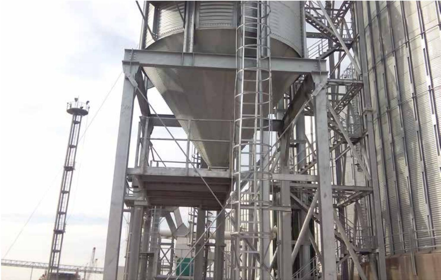
Los silos de carga a granel sobre estructura están concebidos para el almacenamiento y posterior expedición de productos a granel como granulados, harinas, etc...
