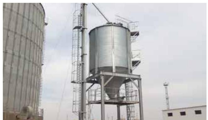
Para instalaciones industriales con silos para expedición a camión o a ferrocarril, recomendamos silos a partir de 4.58 m de diámetro y con capacidades desde 80 a 400 m<sup>3</sup>, bajo petición.
