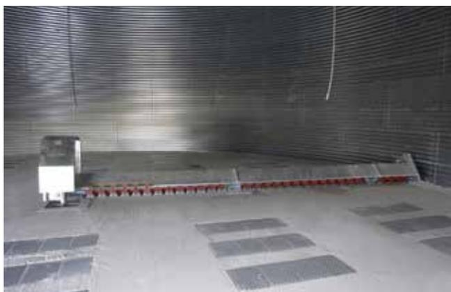
Les **vis-balayeuses** de Silos Córdoba s'adaptent à tous nos diamètres de silo et peuvent être complétées avec des accessoires pour l'optimisation du vidage moyennant l'élimination de tous les restes présents entre la balayeuse et le sol. Elles respectent les exigences de la norme ATEX relative aux opérations à réaliser à l'intérieur des silos.
